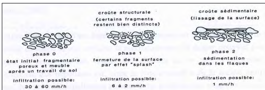
Figure 18 : Stades de formation d'une croûte de battance à la surface du sol sous l'action du splash.
