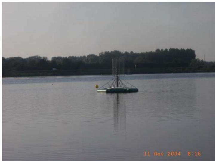
*Figure 1. Aérateur aquatique éolien ou hydrolienne (Société AEROLAC)
