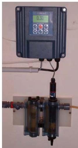
**Figure 19 : analyseur en continu du taux de dioxyde de chlore**
