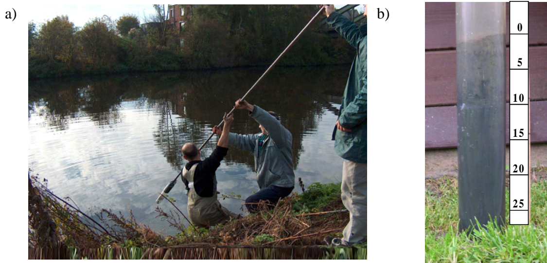
Figure II.1 : a) Photographie montrant la technique de carottage dans le canal de la Lys (Warneton), b) Photographie d'un carottier après prélèvement.
