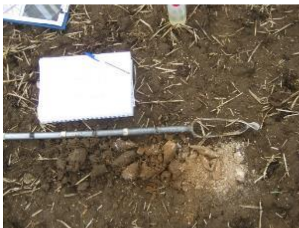
Figure 44 : Exemple de profil d'un sol de limon lœssique moyennement profond sur craie (Suez Consulting, 2015)
